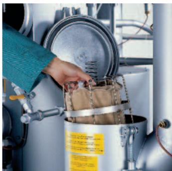
Nur eine Wartungsöffnung für Flusenfilter und Nadelfänger: Mit rundem Gehäuse gibt es keine Ecken für Flusennester
