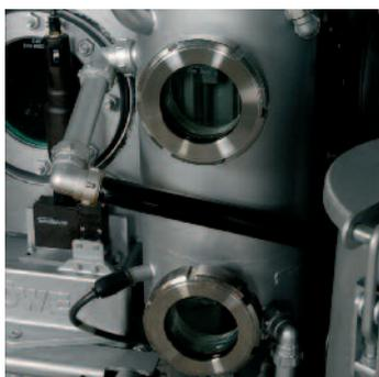
Der neue, selbstreinigende BÖWE Wasserabscheider
